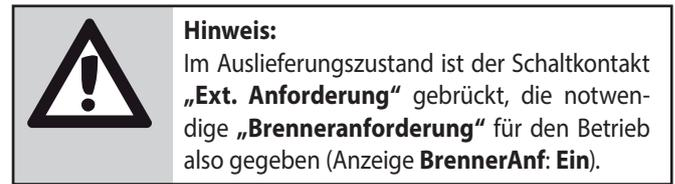
Dabei bedeutet „Brenneranforderung“, dass das Gerät in den Betriebsmodus „Bereit“ wechselt und unter Berücksichtigung der internen Abläufe geregelt und gesteuert wird.
